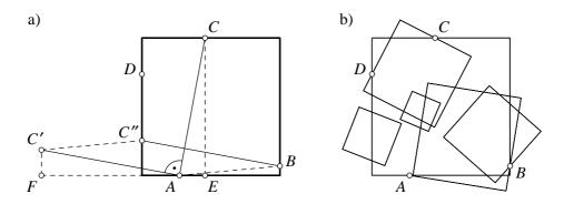
das gesuchte Quadrat. Um einzusehen, daß dem so ist, betrachten wir die rechtwinkligen Dreiecke ACE und AC'F, die offenbar kongruent sind, da sie sich durch eine Drehverschiebung (d. i. die oben beschriebene Drehung mit anschließender Parallelverschiebung) ineinander überführen lassen. Der Abstand der konstruierten Geradenpaare ist dann FA = CE.
