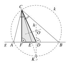
Punkt K als Schnittpunkt der in D senkrecht zu g errichteten Geraden h mit der Verlängerung von CE über E hinaus. Der Mittelpunkt O des Umkreises muß nun seinerseits auf der Geraden h (die zugleich Mittelsenkrechte der noch unbekannten Seite AB ist) und auf der Mittelsenkrechten der Sehne CK liegen; er ist somit ihr gemeinsamer Schnittpunkt. Die beiden Eckpunkte A und B erhalten wir schließlich als Schnittpunkte von g mit dem Umkreis  $O_C$ .
